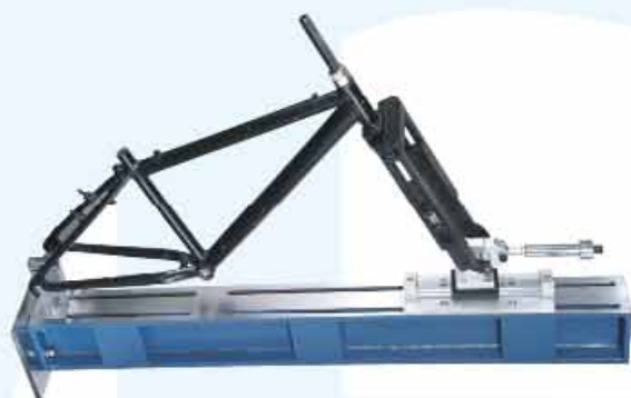
DBG008-A Frame Horizontal Fatigue Test
